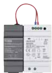
VT200NG3 Art.Nr. 28379 System-Netzgerät für Systeme mit max. 8 Ruftasten, 10 Innenstationen, 2 Türsprechstellen. Bestehend aus Spannungskoppler mit Bus-Anschluss und Netzteil, beides in REG-Gehäuse zur Hutschienenmontage (5 TE).
